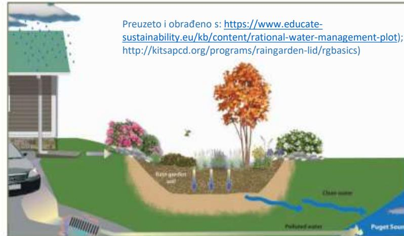
Koncept **infiltracijskog jarka** – zadržavanje, infiltracija i transpiracija vode prije dotoka u odvodni sustav
